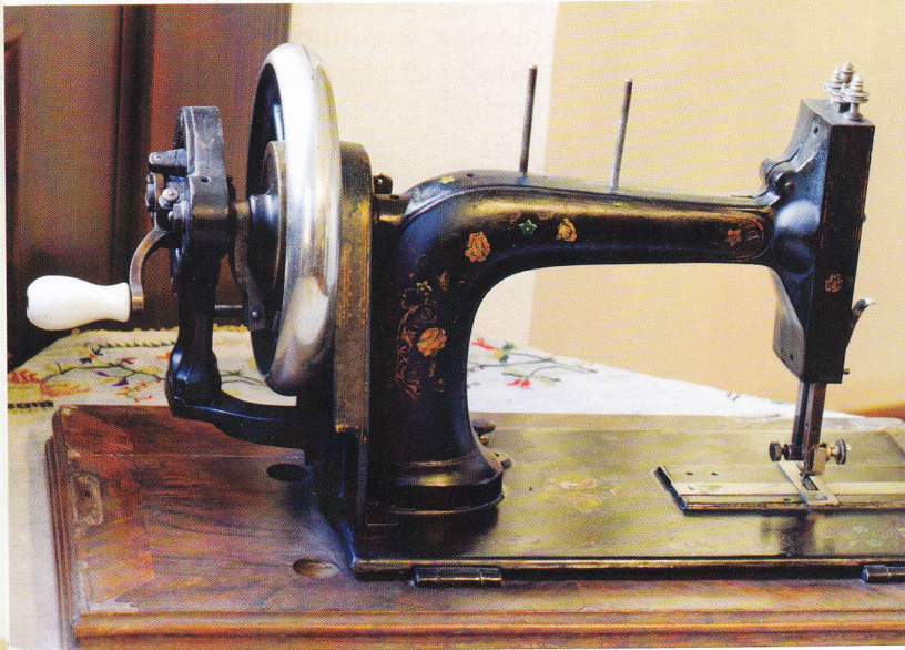
◀ Demir altlığı ve ahşap çevirme kolu olan, siyah renkli dikiş makinesi.
